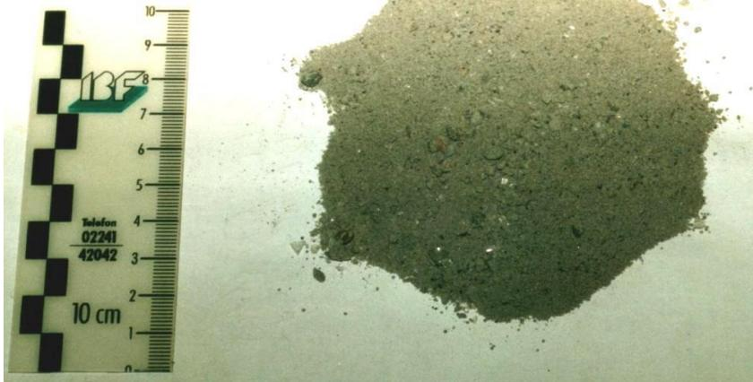
**Fein zermahlene Estrichprobe nach 10-minütigem Aufmahlen im Rahmen der gewerbeüblichen CM-Prüfung gemäß dem gewerkübergreifenden Schnittstellenprotokoll**
